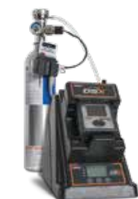
Bộ hiệu chuẩn MX6 iBrid Bộ chia khí hiệu chuẩn 5 cổng cắm (18105924) với Van hiệu chuẩn tự động (18105841) và kết nối với bình khí qua công tắc áp suất iGas (18105684).
